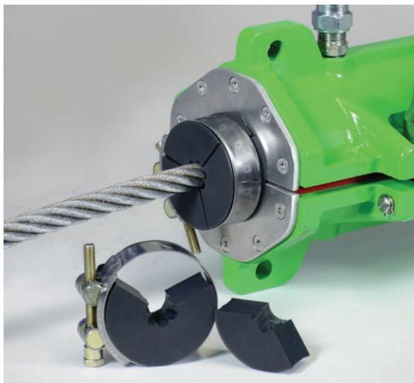
Los limpiadores de cuerda Viper permiten eliminar la contaminación o el lubricante viejo acumulado del cable antes de la lubricación, mejorando la efectividad del proceso de lubricación a través del Viper WRL. Los limpiadores de cuerda Viper (VRC) están disponibles en posición izquierda y derecha, para adaptarse a cuerdas de 6 y 8 hilos y otras configuraciones de hilos bajo pedido.
