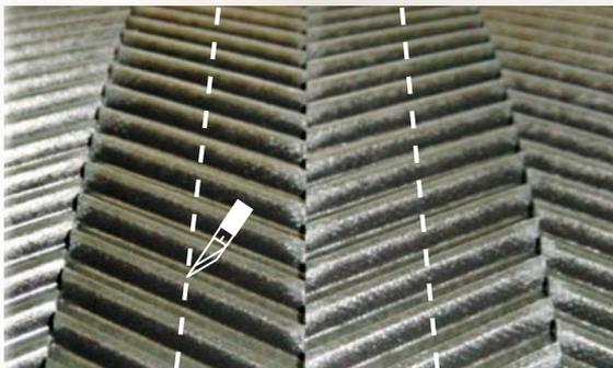
Der SILENTSYNC wird in Wickeln gefertigt. Aus einem Wickel mit dem Versatz zwischen den Pfeilrichtungen von z.B. 64 mm (lila) können demnach entweder Riemenbreiten von 64 mm oder aus zwei Abschnitten jeweils drei 32 mm Riemenbreiten realisiert werden. Auch ein Riemen von 48 mm Breite und zwei von 16 mm Breite sind hierbei möglich.
