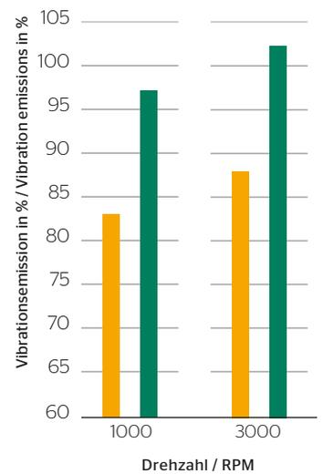
Ruhigere und präzisere Leistungsübertragung durch Schrägverzahnung. Vibrationen können im Vergleich zu herkömmlichen Zahnriemenantrieben um bis zu 20 % reduziert werden.
