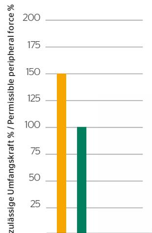
Die speziellen Materialien des SILENTSYNC erlauben es, die Riemenbreite und das Gewicht zu reduzieren, ohne Kompromisse bei der Übertragungsleistung und der Laufzeit einzugehen. Durch die Selbstführung des Riemens werden keine Bordscheiben benötigt, was eine weitere Breiten- und Gewichtsreduzierung mit sich zieht.
