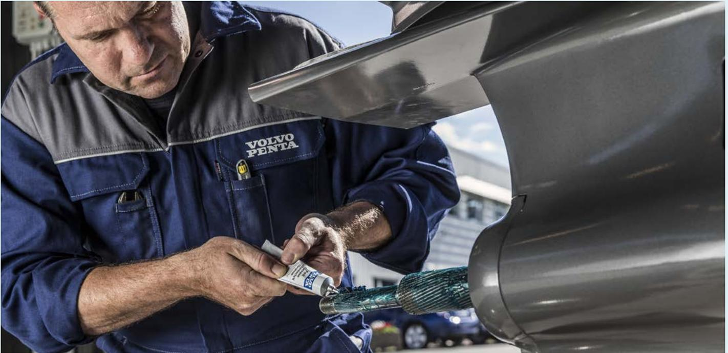
**Engráselo.** El eje de la hélice debe limpiarse y volver a engrasarse como mínimo una vez al año y siempre que se sustituya la hélice. La lubricación periódica con grasa previene que la hélice se adhiera a la hélice. Para los intervalos recomendados, véase el Manual de instrucciones.
