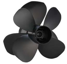
**¡Atención!** Siempre deben usarse hélices del tipo F o FH de acero inoxidable en motores con una potencia mayor a los 240 CV, o que puedan alcanzar velocidades por encima de los 38 nudos (45 mph). Véase la página siguiente.
